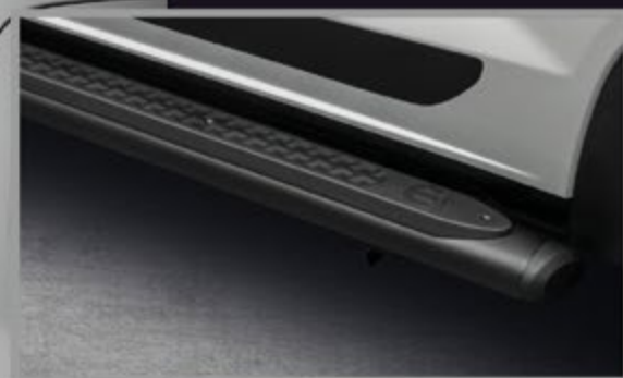
ESTRIBO LATERAL TUBULAR
